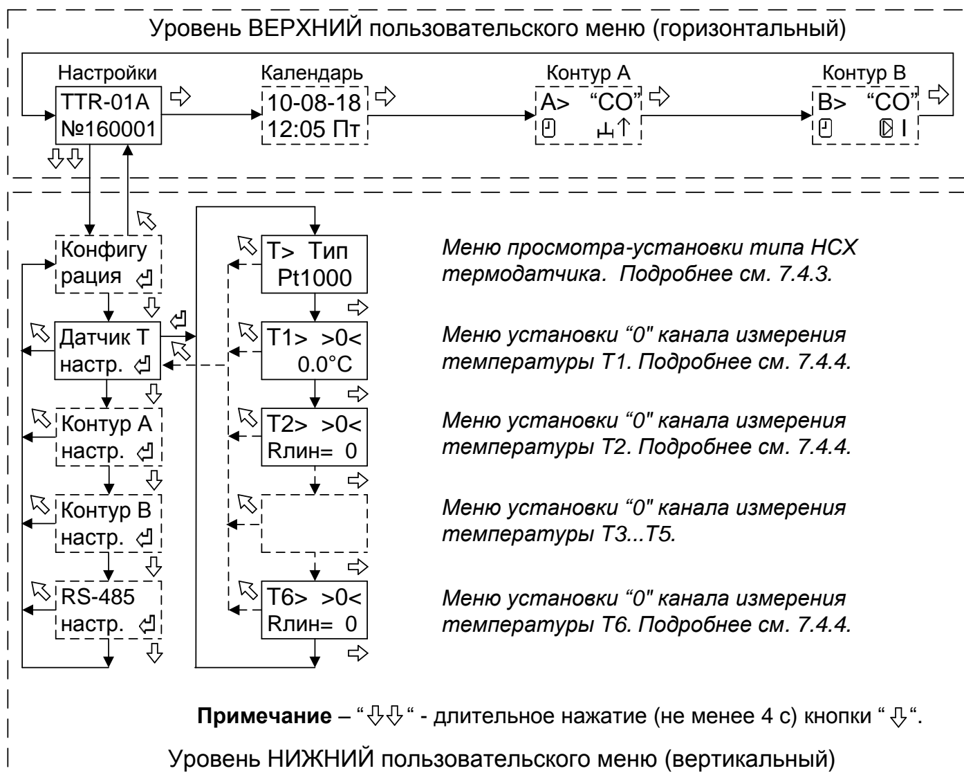
Рисунок 3 - Структура меню настройки канала измерения температуры
